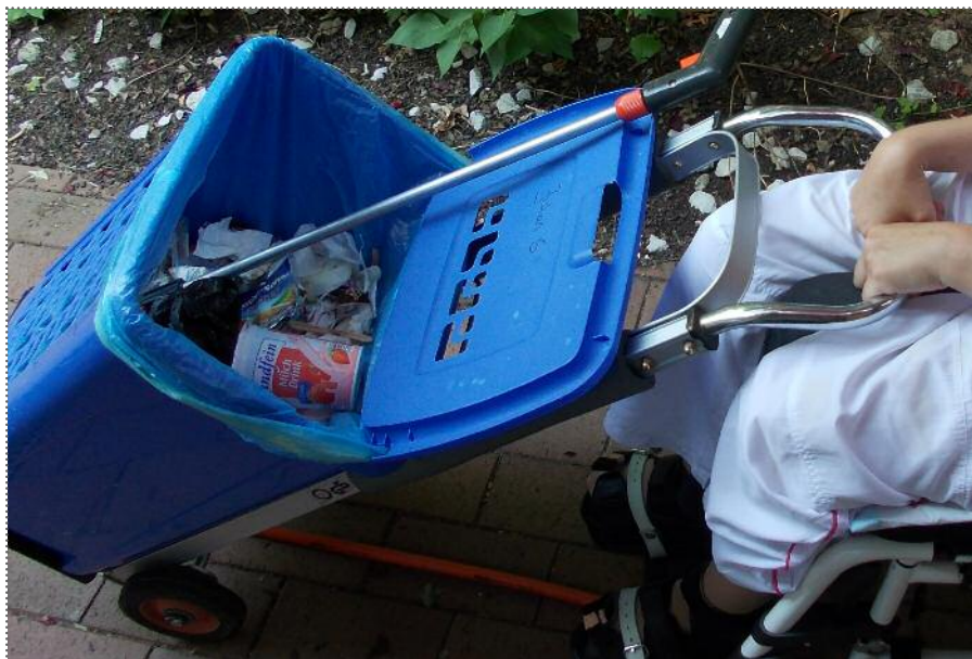
Abb. 1: Arbeitshilfe für Rollstuhlfahrer zum Mülleinsammeln
