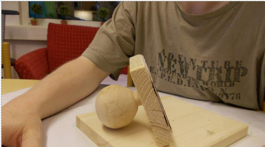
Abb. 4: Arbeitshilfe Schleifblock mit Kugelgriff
