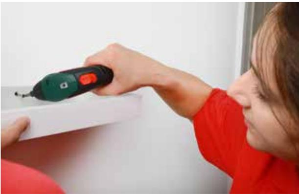
Oder du benutzt einen Akku-Schrauber. Das ist ein Bohr-Schrauber mit Akku. Mit diesem Werkzeug kannst du leicht Schrauben eindrehen. Weil der Bohr-Schrauber Akkus hat, brauchst du dabei kein Stromkabel. Der Akku-Schrauber hat für alle Schrauben den passenden Aufsatz.
